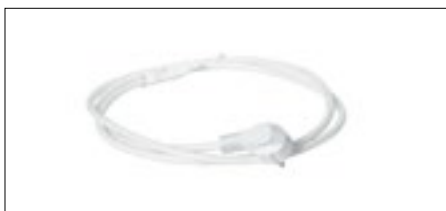
Aansluitsnoer, 3-polig, 1-fase. L=2,0m met Wieland aansluiting aan de armatuurzijde en gearde stekker 2-polig + RA 3 × 1,5mm 2
