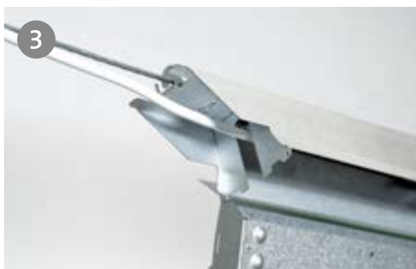
Het aansluitsnoer kan door een gleuf in de eindkap gelegd worden en wordt met een kabelhouder vastgezet.
