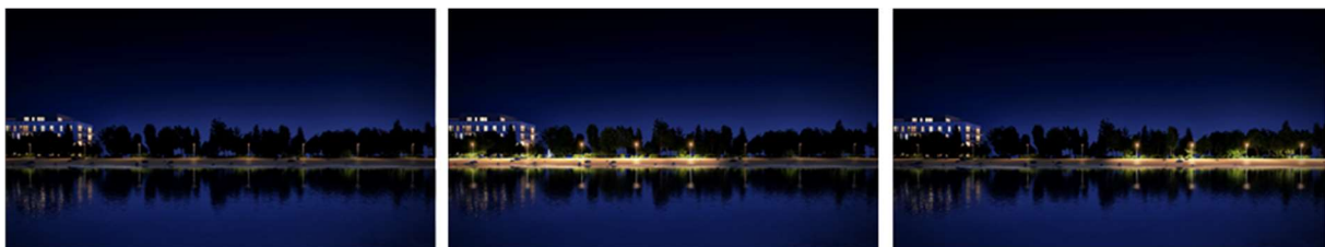
Beeld 10 : De verschillende fasen van e-Sense motion: links - de armaturen worden door een aanwezigheidsdetectie gedimd tot een laag niveau; midden - wanneer er aanwezigheid wordt gedetecteerd, lichten een bepaald aantal armaturen ervoor op; rechts - de armaturen blijven verlicht achter de aanwezige voor een bepaalde tijd.
